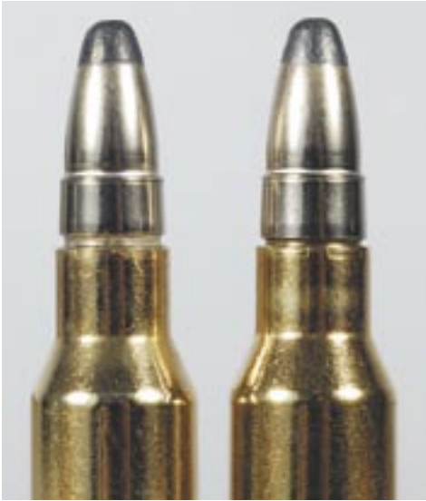
Unterschiede. Bei der .300 Win. Mag. von RWS ist der Abrissstopp ungleichmäßig angebracht.
